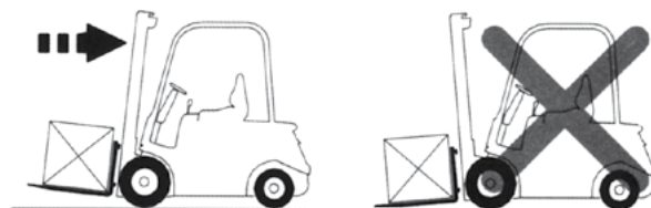
ERRATA INCLINAZIONE DEL MONTANTE
