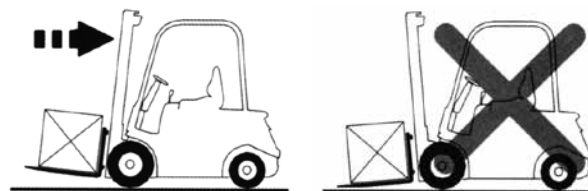
ERRATA INCLINAZIONE DEL MONTANTE
